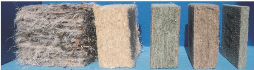
Abb. 34: Verschiedene Bindertypen (von links) aus Seegrass und Hanf, Holzfaser sowie Holzfaser mit verschiedenen Zusatzstoffen
