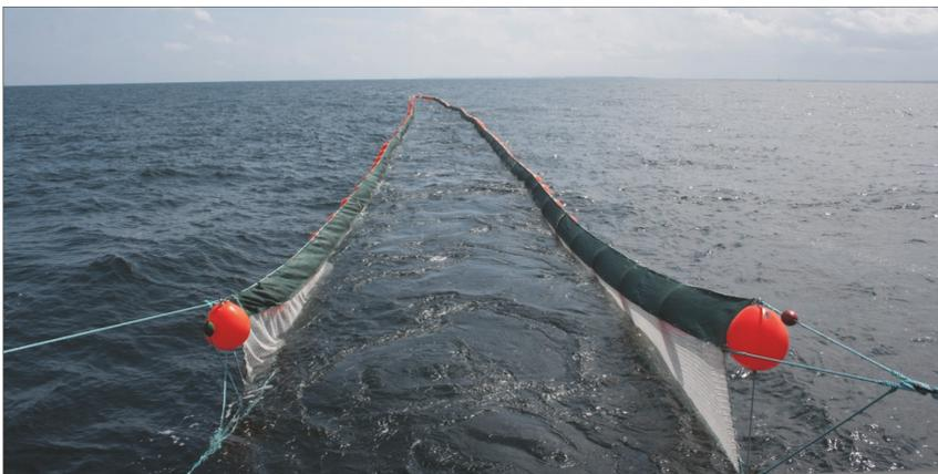
Abb. 37: Auslegen der Netzsperrre während Freilanduntersuchungen auf der Ostsee (Foto: Universität Rostock – Lehrstuhl für Meerestechnik).
