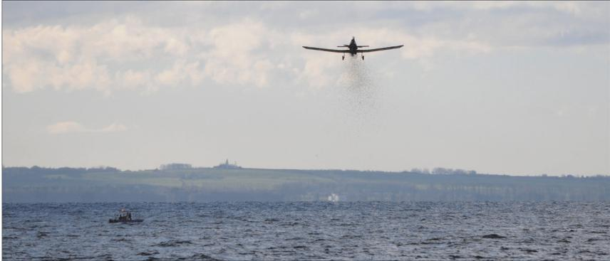
Abb. 36: Binderabwurf aus dem Kleinflugzeug Dromedar M-18 auf der Ostsee (Flughöhe ca. 25 m), (Foto: Safonova)
