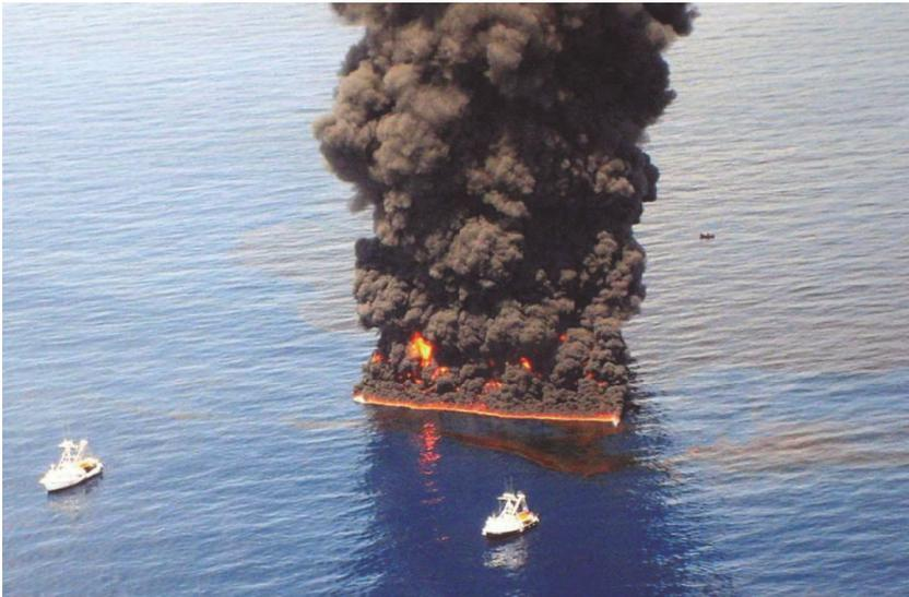
Abb. 11: In-situ Verbrennung von Öl auf der Wasseroberfläche innerhalb der Grenzen einer Ölsperre im Golf von Mexiko (Allen et al. 2011)
