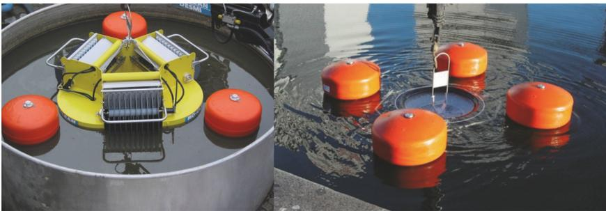
Abb. 7: Disk Skimmer (links) und Wehr Skimmer (rechts) beim Einsatz in ruhigen Gewässern (DESMI A/S 2018)
