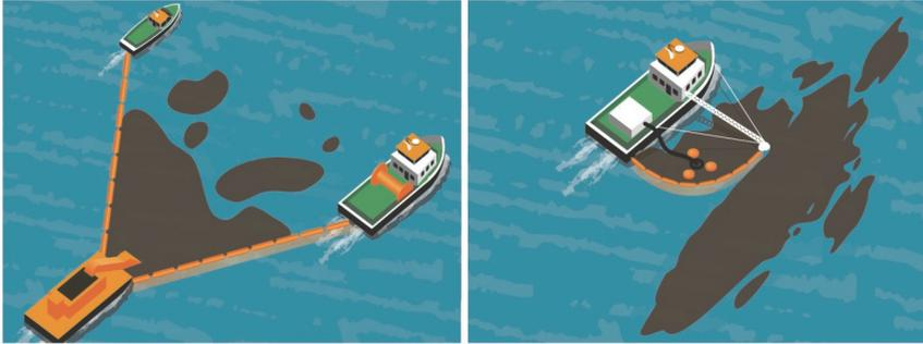
Abb. 8: Geschleppte Ölsperren in Kombination mit einer Ölaufnahmeeinrichtung am Ende der Ölsperre (links) sowie fest installierte Ölsperre und Aufnahmeeinrichtung an der Seite eines Bekämpfungsschiffes (rechts) (Oil Spill Response 2011)
